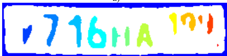
Рис. 5. а) Изображение до обработки; б) изображение после использования алгоритма маркировки связанных компонент
