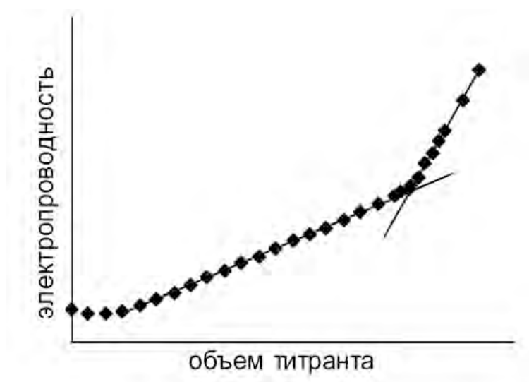
Рис. 7. Кривая кондуктометрического титрования хлоридов нитратом серебра
