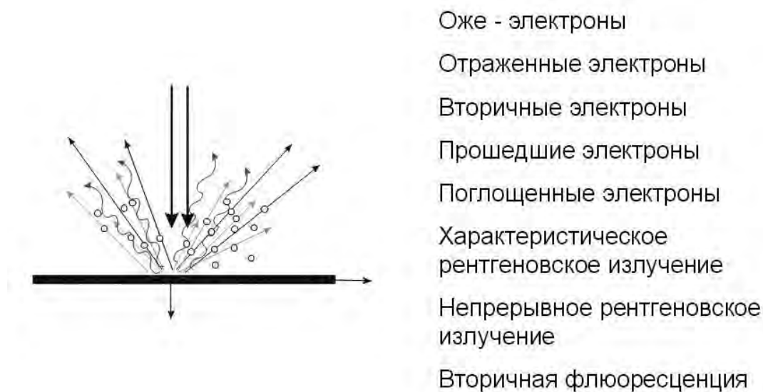
Рис. 15. Типы излучений, возникающие при взаимодействии электронов с объектом
