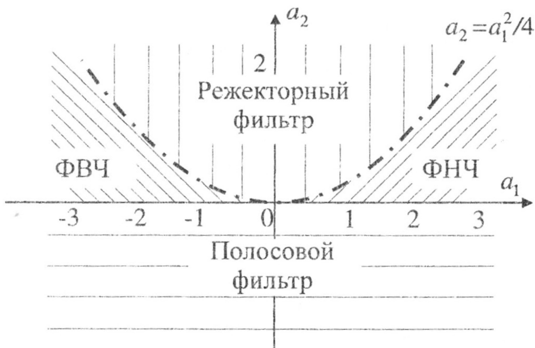
Рис. 3.11. Разбиение плоскости параметров нерекурсивной цепи второго порядка
