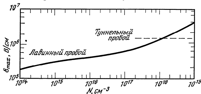
Рис. 4.2.1 Зависимость критических электрических полей лавинного и туннельного пробоя в кремнии от примесной концентрации.
